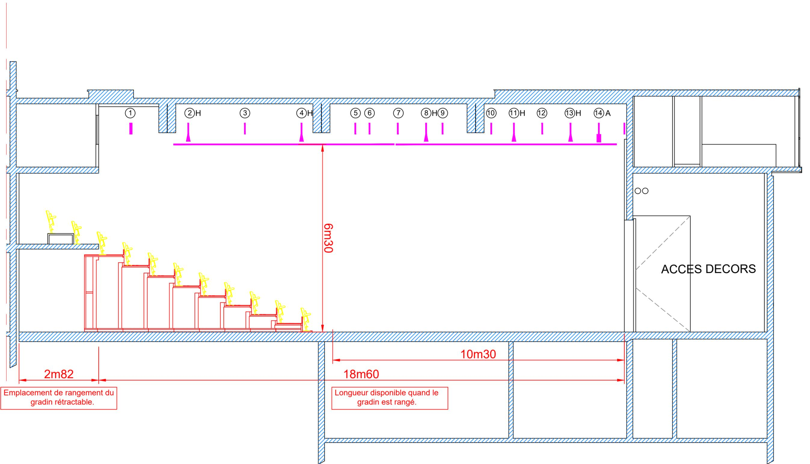
Emplacement de rangement du gradin rétractable.
